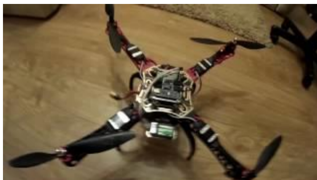
Сурет 3.19 – Arduino микроконтроллері негізінде құрылған квадрокоптердің соңғы макеті
